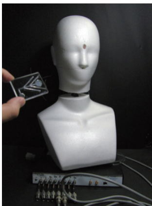
膜タンパク質を特異的に発現させた匂いセンサをもつロボット
