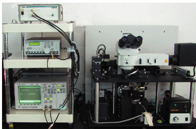
「非接触で顕微鏡下の局所的粘弾性を測定する電界ピンセットシステム」
