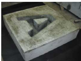
内部空洞を模擬した供試体
