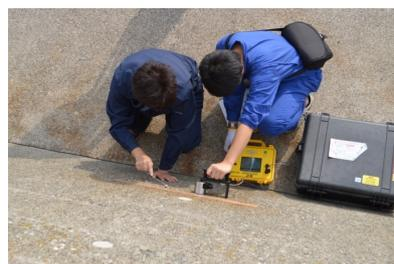
図3. 海岸構造物の劣化調査
