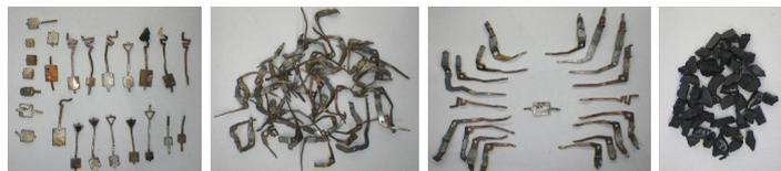
中心部の金属素材      足部分      部品内部の金属      プラスチック
