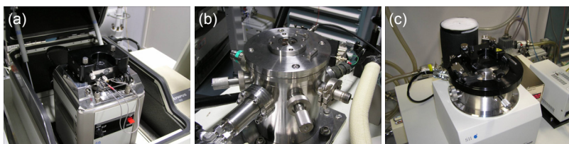
多機能SPMユニット: (a) 大気型, (b)(c) 温度可変高真空型
