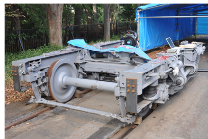
ICAによる鉄道台車の振動解析
