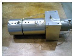
振動体 2組の振動機構を組み合わせて振幅調整が可能となる。
