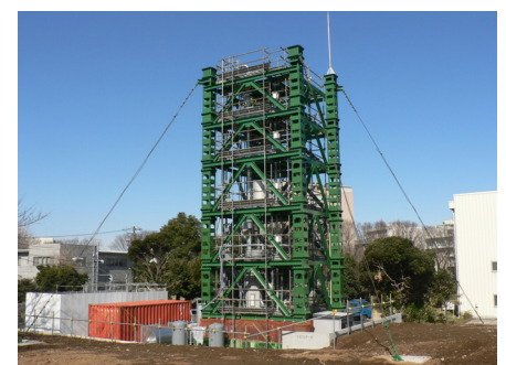
千葉実験所 大型循環流動層コールドモデル (高さ16 m, 直径0.10 m)
