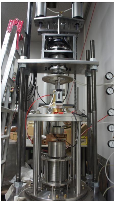
図1. 多層リング単純せん断試験装置
