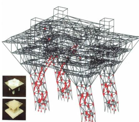
大規模骨組構造の地震による塑性崩壊
