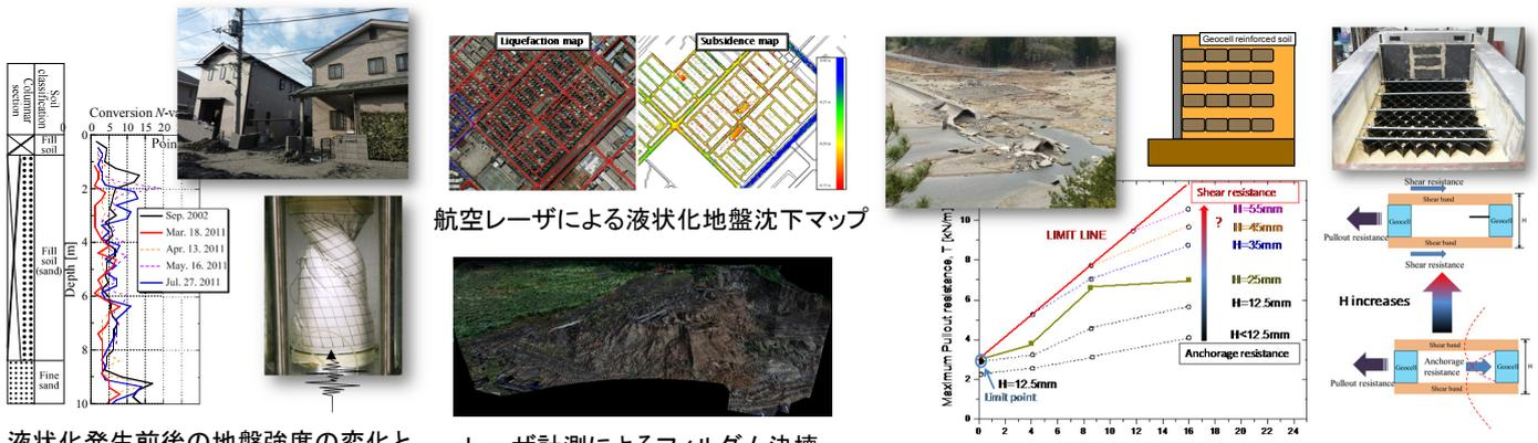
液状化発生前後の地盤強度の変化と中空供試体による液状化実験
