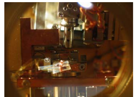
図6. 光励振・光検出AFMによる場の高速計測
