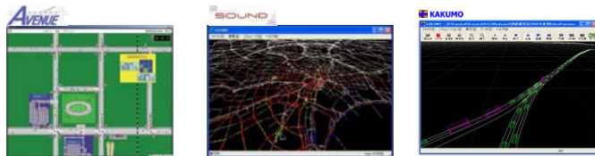
街路交通シミュレータ 渋滞緩和策評価などに使用 ネットワーク交通シミュレータ 数十Km範囲の広域を対象 ミクロ交通シミュレータ TSとDSを接続
