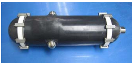
セラミックス製耐圧容器縮尺模型（最大水深11000m対応、全長約40cm）
