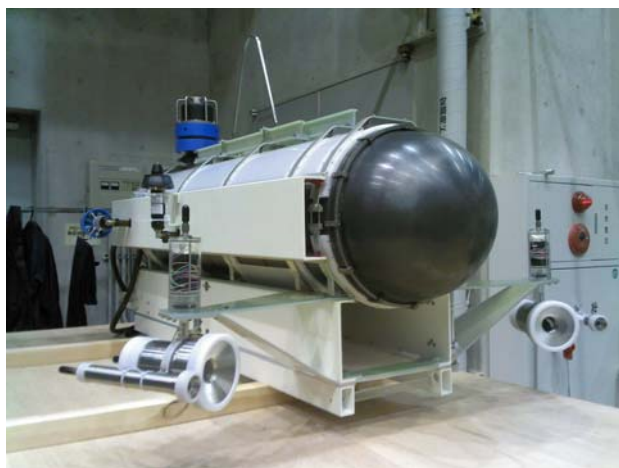
セラミックス製耐圧容器縮尺模型（最大水深11000m対応、全長約40cm）
