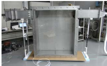
■都市キャニオンを模擬した空間における二分子化学反応を伴う大気汚染物質の拡散実験
