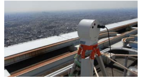
■シンチロメータを用いた都市域の顕熱フラックス実測
