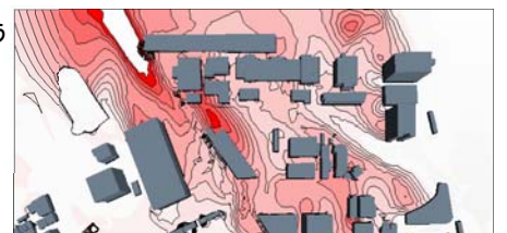
■放射・対流連成解析システムを用いた人工排熱による都市空間の気温上昇予測
