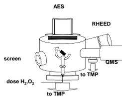
表面分析のための超高真空槽。背圧は $10^{-9}$  Paに達する。RHEED, AES, QMSとガスクラッキング機構により表面の構造、化学結合種、脱離種の計測が可能となる。
