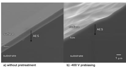
DLC/Si界面の断面SEM像。基板の前処理を行うことにより(b)明瞭な界面が消失し、膜が連続的に基板への移行していることがわかる。
