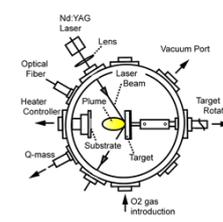
Nd:YAGレーザー源を有するパルスレーザー蒸着装置。意図しない不純物の混入を極力避けるため、 $10^{-7}$  Paの背圧を維持している。
