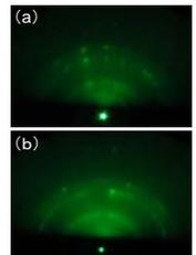
酸素中での熱処理の(1)前と(2)後のRHEED像。COとしての脱離に伴い、表面の結晶構造が乱れていることがわかる。
