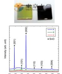
SnとOフラックスの制御により、ガラス上にも結晶配向したSnO薄膜が得られる。
