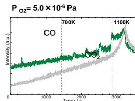
酸素雰囲気での熱処理におけるダイヤモンド表面からの脱離種。ダイヤモンドを熱した酸素が $O_2$ の形で可逆的に脱離することは無く、必ず表面のエッチングを伴い、COとして脱離する。
