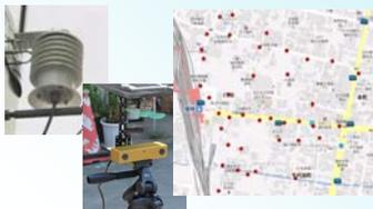
気温、湿度情報を検知する微気象センサーノード(左)と、人流情報を検知する差分ステレオカメラ(中)の画像及びセンサーの配置マップ(右)を示す。
