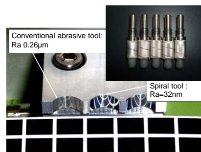
無限気孔を有する固定砥粒工具
