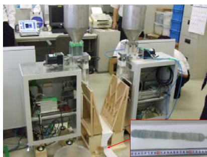
粉体の立体混合装置と、それを用いたAl 2 O 3 とSiCの混合物
