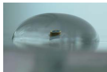
図4. 微量サンプル用 誘電測定プローブ
