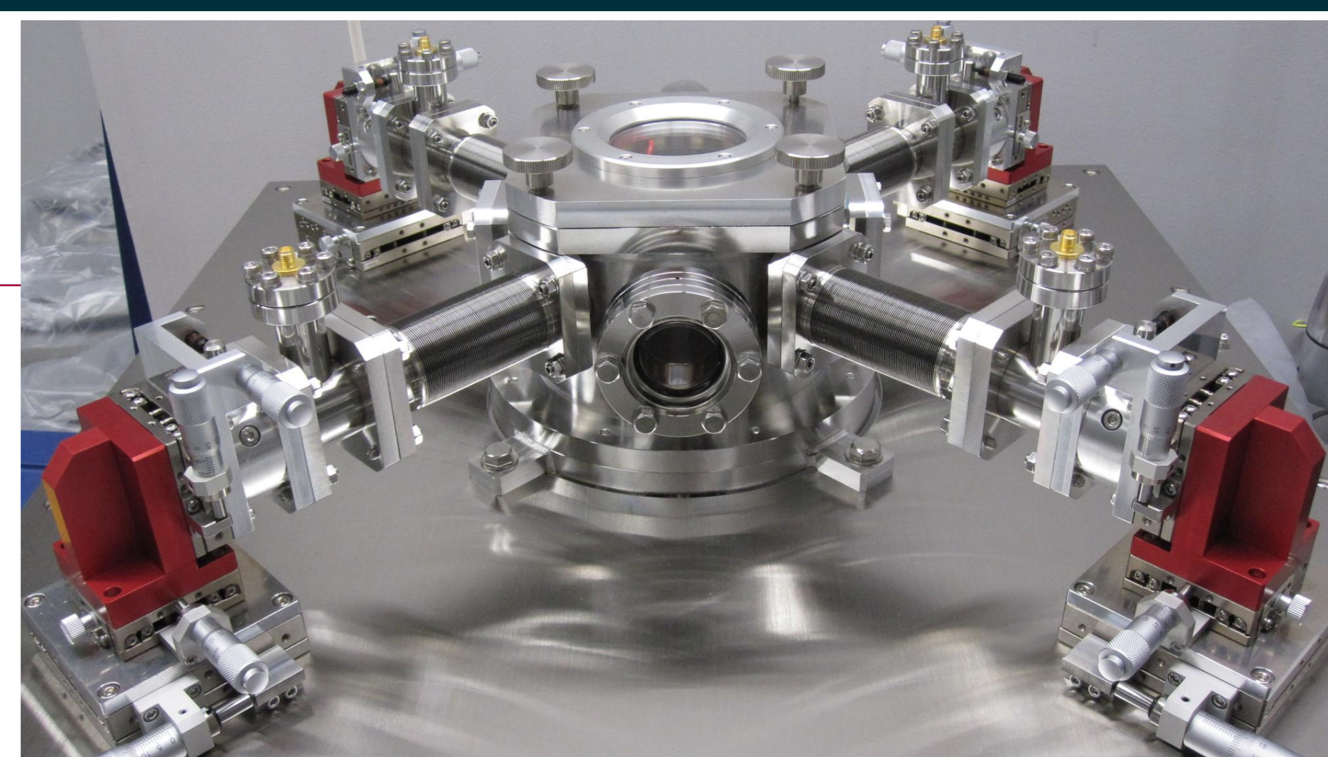
高周波プローブステーション
