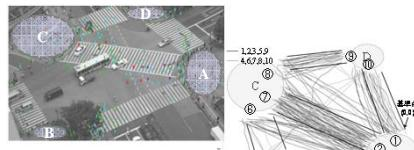
歩行者の挙動を分析するためのミクロシミュレーション及び経路選択モデルの構築。
