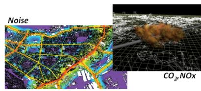
交通シミュレーションモデルと、 $\text{CO}_2, \text{NO}_x$ 排出モデルや道路騒音モデルとの統合化による環境評価ツールを開発。
