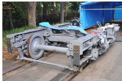
ICAによる鉄道台車の振動解析
