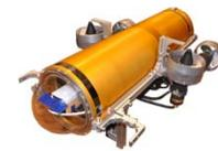
水中ロボコン競技用AUV (YebisUra, HAL-urabo)
