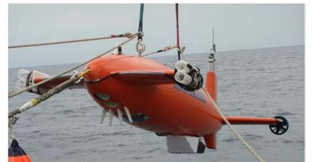
熱水鉱床調査AUV Aqua-Explorer 2000
