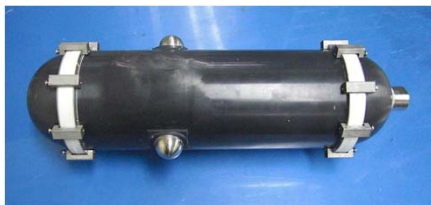
セラミックス製耐圧容器縮尺模型 (全長約40cm)
