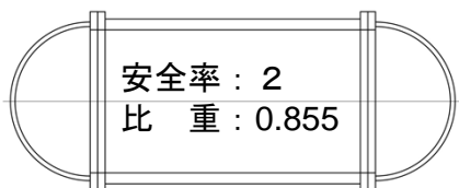
軽比重耐圧容器の開発。窒化珪素セラミックス製耐圧容器。11000m水深対応。
