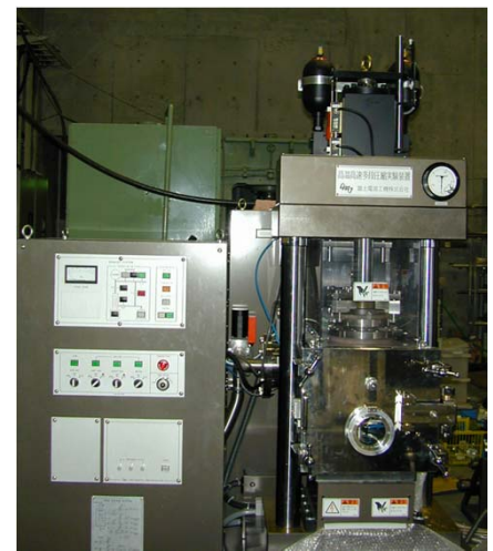
高いずみ速度付与試験設備
