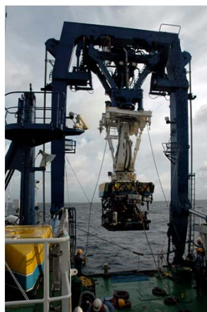
マンガンイオン定量分析装置を搭載したROV「ハイパードルフィン」
