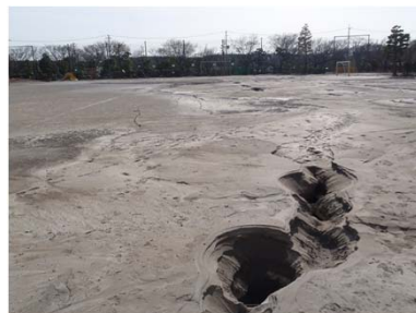
至る所で発生した液状化(浦安市)余震や将来の地震による再液状化の可能性はあるのか?
