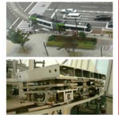
急曲線を走行可能なLRT用台車とこれがもたらす乗降の安全性向上及び道路の有効利用
