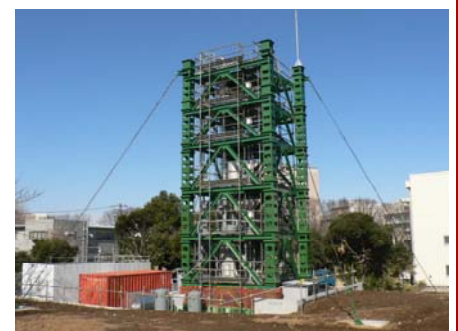
千葉実験所 大型循環流動層コールドモデル (高さ15.7 m, 直径0.10 m)
