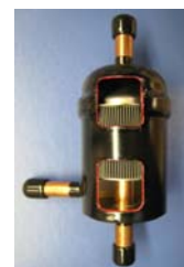
図6 表面張力利用気液分離器
