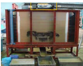
水平方向の水の浸透による空洞の発達 → 空洞上部の不安定な土塊の崩落
