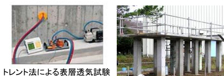
トレント法による表層透気試験
