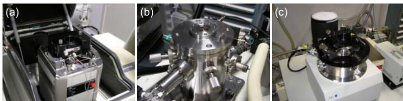
多機能SPMユニット: (a) 大気型, (b)(c) 温度可変超高真空型
