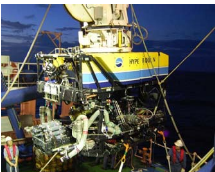
pHセンサを搭載したROV「ハイパードルフィン」
