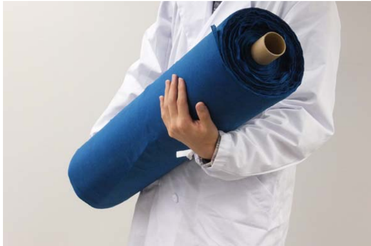
図 1. 開発した量産型放射性セシウム除染布 (プルシアンブルーを不織布に固定したもの)
