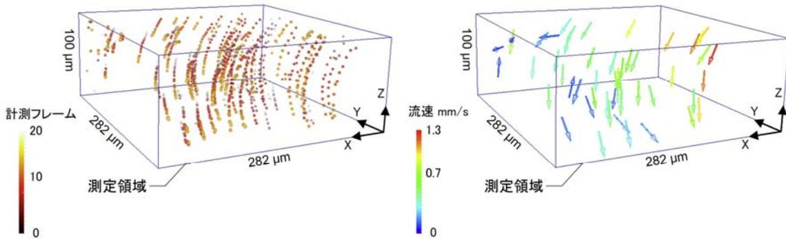
DHM-PTV を用いてマイクロ流れの流速分布を 3 D測定した結果。(左) 検出された粒子重心位置の軌跡、(右) 粒子を追跡して得られた 3 次元流速ベクトル
