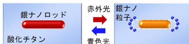
図3. 酸化チタン上の銀ナノロッドの反応(模式図)。光によって長さが変化し、吸収する波長も変わる。
