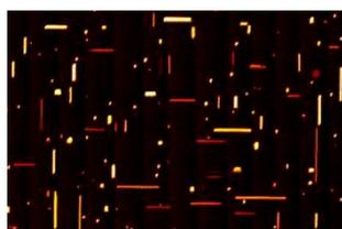
図2. 酸化チタン上の銀ナノロッド（原子間力顕微鏡像）。長さは数十～数百ナノメートル。
