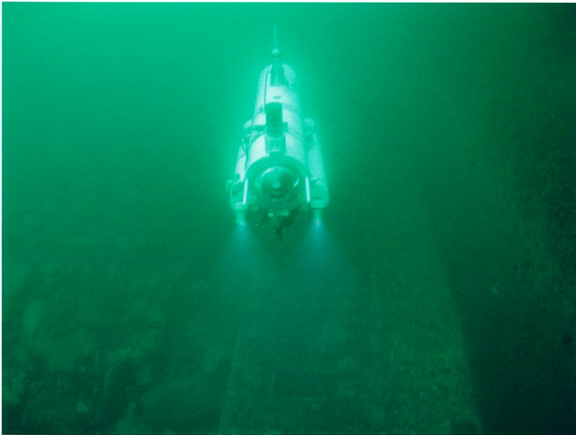
海底面に沿って 与えられた航路 をトレースする トライドッグ1号 および 根固めブロック のモザイク
