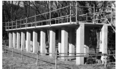
写真1 検討に使用した高架橋模型
