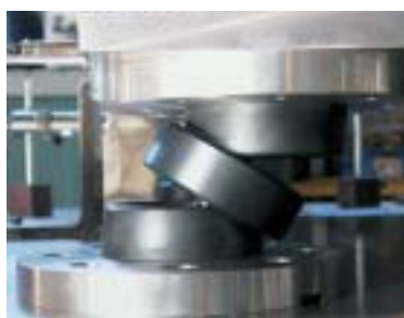
ハイブリッドロッキングコラム型免震装置（地震時）
