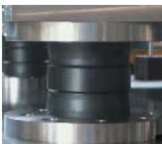
ハイブリッドロッキングコラム型免震装置（常時）
