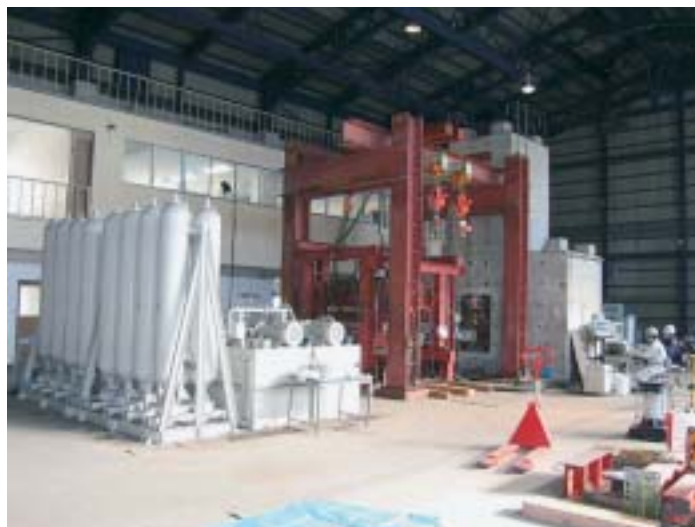
新型免震装置の高速アクチュエータ試験
