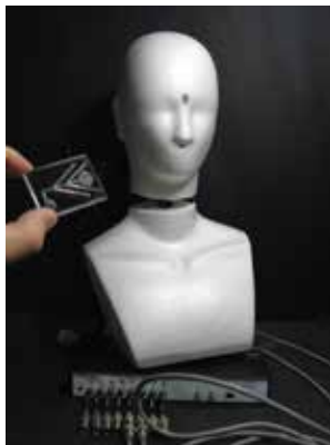
細胞を使ったセンサを搭載したロボット A cell-based odorant sensor mounted on a robot
