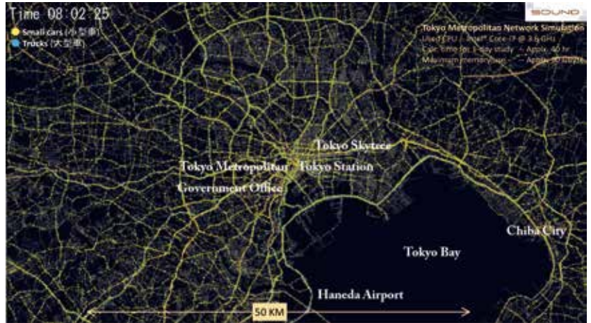
東京都圏三環状道路概成時の交通状況推定のための大規模ネットワーク 交通流シミュレーション Large-scale network traffic simulator for estimating the traffic situation after the construction of the Tokyo Metropolitan Urban Expressway Rings
