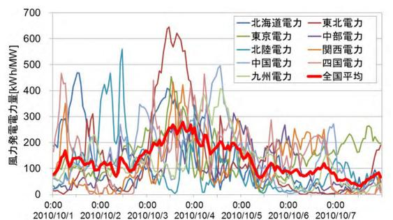
風力発電電力容量の変動例
