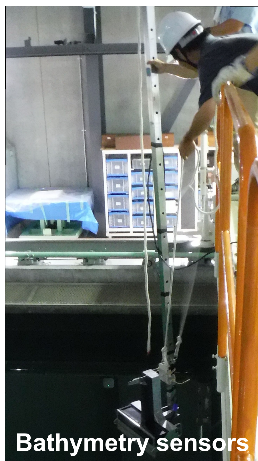
Fig4: マルチビーム測深器の実験風景
