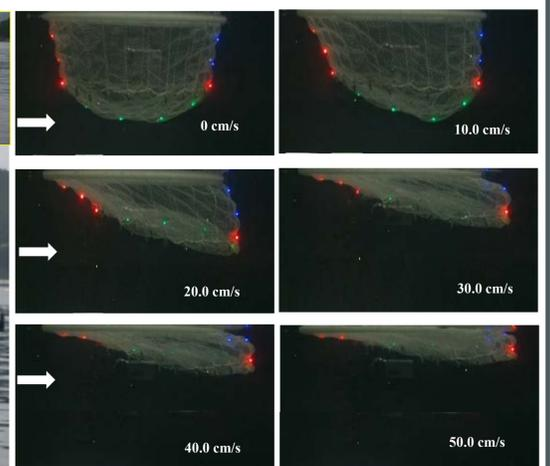
柔軟な網生簀構造物の変形
