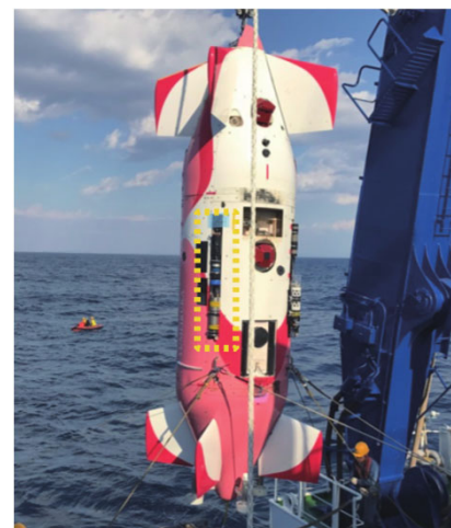
無人探査機に搭載された現場型 ATP 定量分析装置 (YK17-05)
