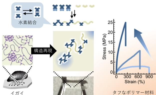
イガイ（ムール貝）は、その身体を岩に固定するために強靱な足糸を持っています。このような生体組織に共通して見られる、動的結合による多相構造を人工ポリマー材料中に再現することで、タフなポリマー材料を開発しました。
