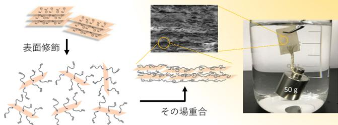
貝殻の内側に形成される真珠層は板状無機物と有機ポリマーが規則的に積層した有機/無機ナノハイブリッドであり、極めて高い剛性と低い物質透過性が特徴です。しかし、真珠層を人工的に模倣した材料は、無機物の親水性により水や湿気に弱いという欠点がありました。私たちは無機物表面の疎水化とその場合重合により、高剛性かつ高耐水性な有機/無機ナノハイブリッドを開発しました。
