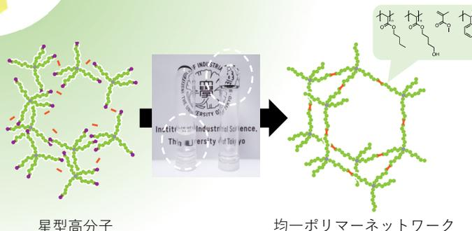
車のタイヤのゴムなどの弾力のあるポリマー材料は、無数の鎖状のポリマーどうしを橋架けした三次元のポリマーネットワークでできています。しかし、その構造は乱雑で、そのことが材料の強度などに影響を及ぼすことが知られています。私たちはさまざまなポリマーからなる構造の均一なネットワークの合成法を開発しました。
