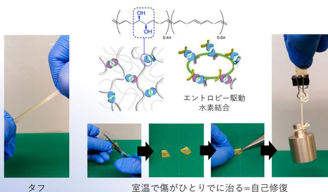
もしもゴムなどの材料が傷をひとりでに治すことができたなら？ 材料の寿命は大きく改善されるでしょう。私たちは極めてシンプルな分子モチーフ（ビシナルジオール）の導入によりタフな自己修復性のゴム材料を開発しました。
