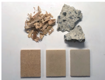
コンクリートがれきと 廃木材から作られたボタニカルコンクリート
