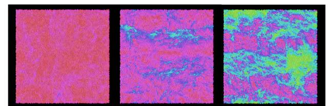
図4. 剪断下の過冷却液体に出現するシアバンド形成：非ニュートンレオロジーに付随して異方的な動的構造が形成される。
