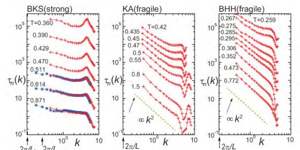
図2. 密度揺らぎの緩和時間の波数依存性 strong液体では緩和が非拡散的であるのに対して、fragile液体では拡散的になる。
