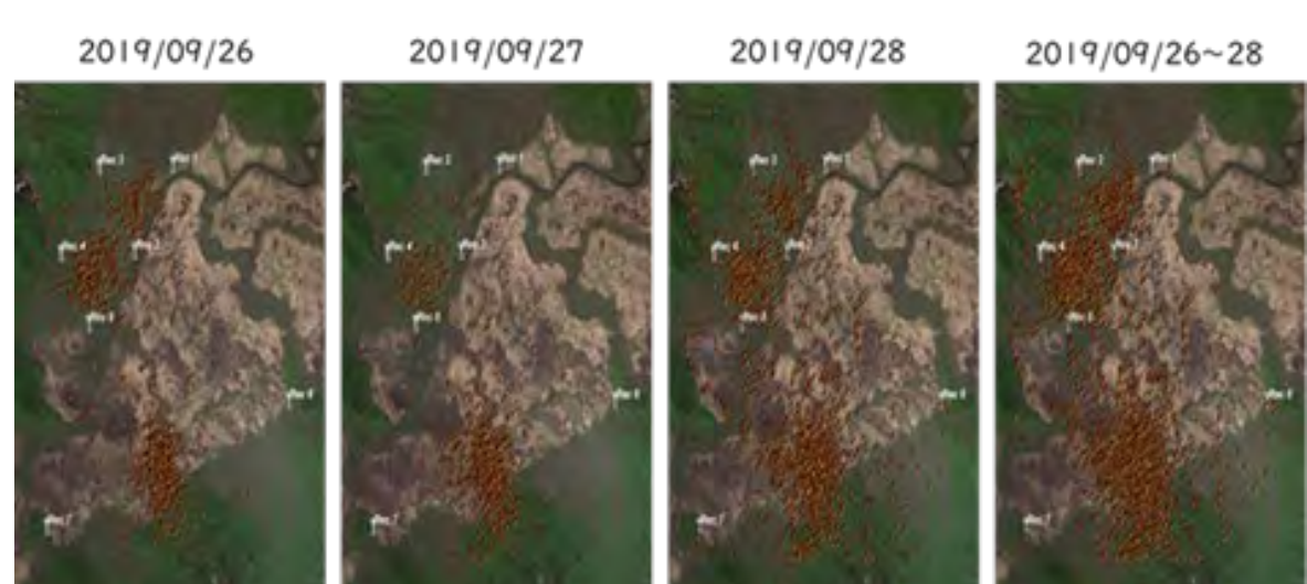
複数マイクロフォンによりシカの鳴き声の位置を可視化
